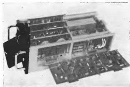
Equipaggiamento elettronico per telecamera completamente a transistori.
