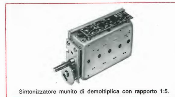
Sintonizzatore munito di demoltiplica con rapporto 1:5.
