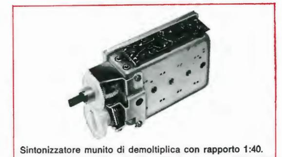
Sintonizzatore munito di demoltiplica con rapporto 1:40.
